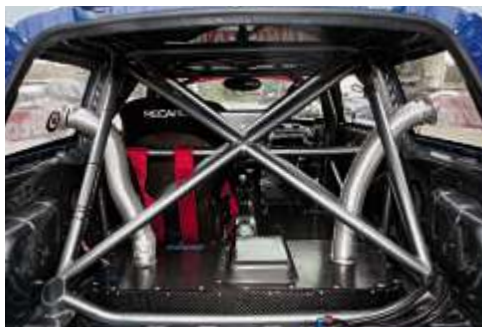
Langstreckentauglich: verstärkter Käfig, Tankvolumen von 50 auf 100 l vergrößert
