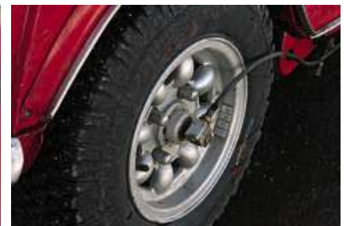
Kilometerzähler hinten: gegen ungenaue Werte des Fronttrieblers bei Wheelspin
