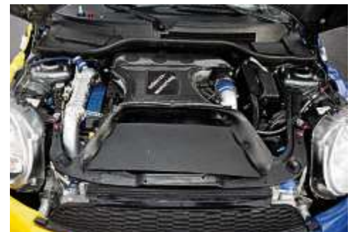
Dampfhammer: 1,6-Liter-Reihenvierzylinder mit Direkteinspritzung und 275 PS
